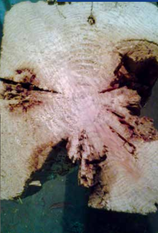
4–5. kép Födémről eltávolított 18/23 cm keresztmetszetű gerenda, mely csőrepedés miatt vályúsán bekorhad
